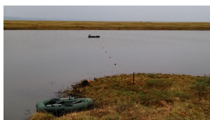
Электротомография с поверхности озера Аппаратура располагается в надувной лодке
