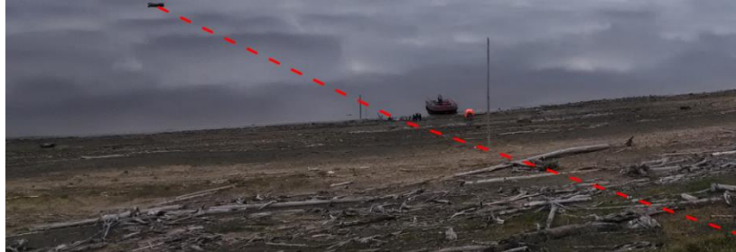
Стационарные береговые зондирования Аппаратура размещается на урзе воды, линия прокладывается ортогонально берегу
