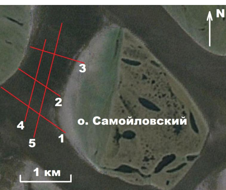
Схема работ методом CRP на Б.Туматской протоке (дельта р.Лена) Цифрами обозначены номера профилей
