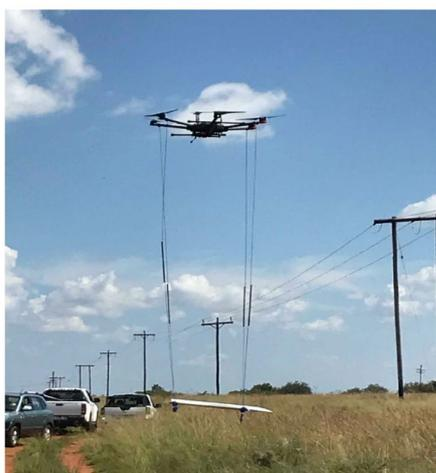
**Рисунок 1.** Гексакоптер DJI 600 Pro с подвеской, где размещены магнитометры.
