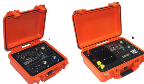
Рисунок 1. Аппаратура мЗСБ FastSnap: слева – измеритель, справа – коммутатор тока.
