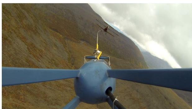
**Рисунок 8.** Частотная система с нежестким креплением передатчика относительно приемника EM-4H во время съемки, 2014 г.
