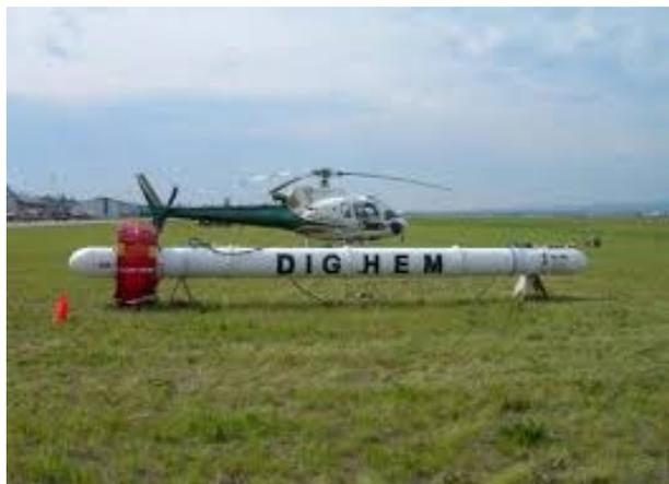
**Рисунок 7.** Частотная система с жестким креплением передатчика относительно приемника DIGHEM.
