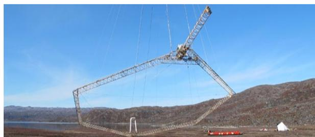
**Рисунок 9.** Комбинированная система SkyTEM.
