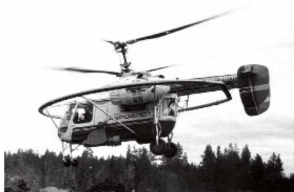
**Рисунок 5.** Активная система, реализующая аэрометод переходных процессов АМПП-2, 1970-е.
