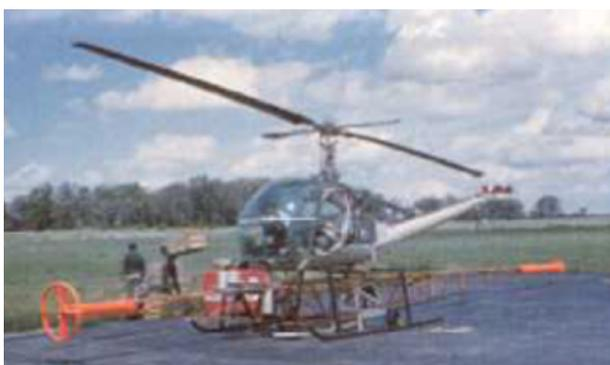
**Рисунок 4.** Частотная система с жестким креплением передатчика относительно приемника Texas Gulf Sulphur, 1964 г.
